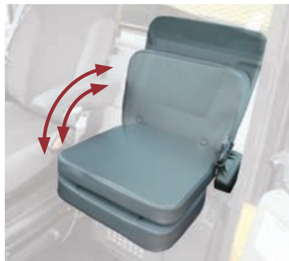
El asiento, de grandes dimensiones, es abatible para facilitar el acceso a la cabina, al filtro del aire acondicionado y a la guantera.
