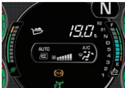
La báscula dinámica muestra el peso de la carga
