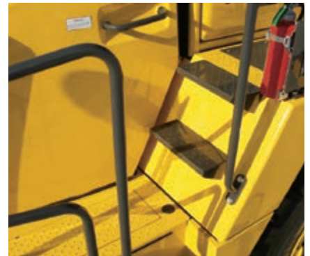
Acceso seguro a la cabina con barandillas, lejos de la peligrosa articulación
