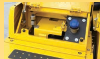
Para facilitar el acceso, el depósito AdBlue® se encuentra instalado en la escalera delantera.
